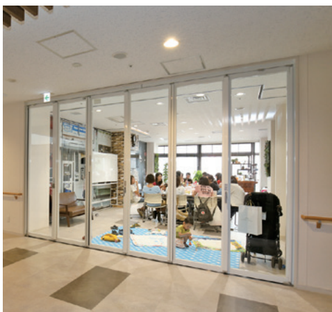
定員30名と20名の2室ある「地域交流スペース」。間仕切りを外せば50名対応の1室としても利用できる。
